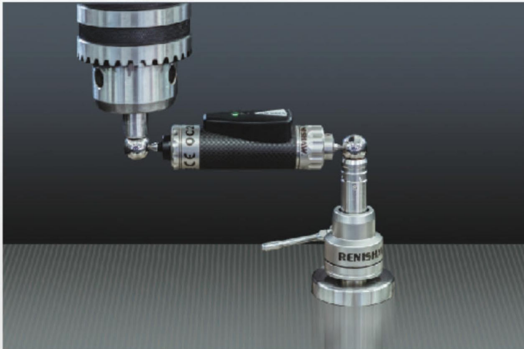
英国Renishaw球杆仪循圆度检测 UK Renishaw roundness detection
